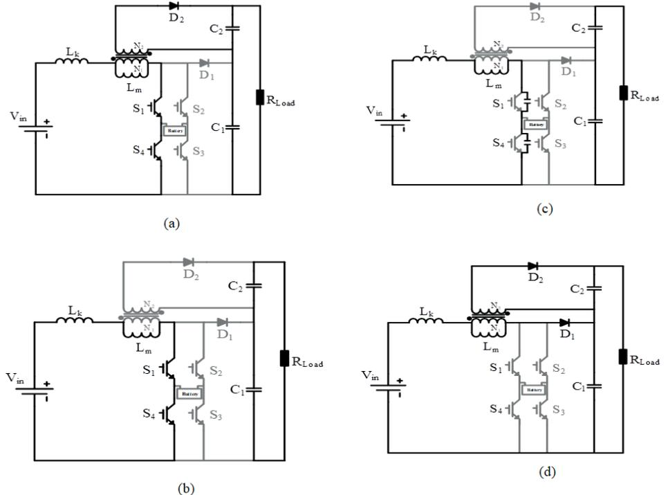
Figure 4: Sub-modes of the proposed converter in mode-II: (a)  $[t_0-t_1]$ , (b)  $[t_1-t_2]$ , (c)  $[t_2-t_3]$ , (d)  $[t_3-t_4]$ , (e)  $[t_4-t_5]$
