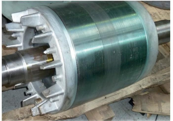
2. Die Cast Aluminium Rotor.
