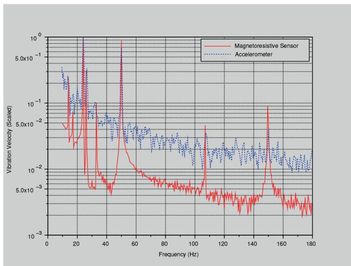
(d) Measurement with motor halted (0 rpm).
