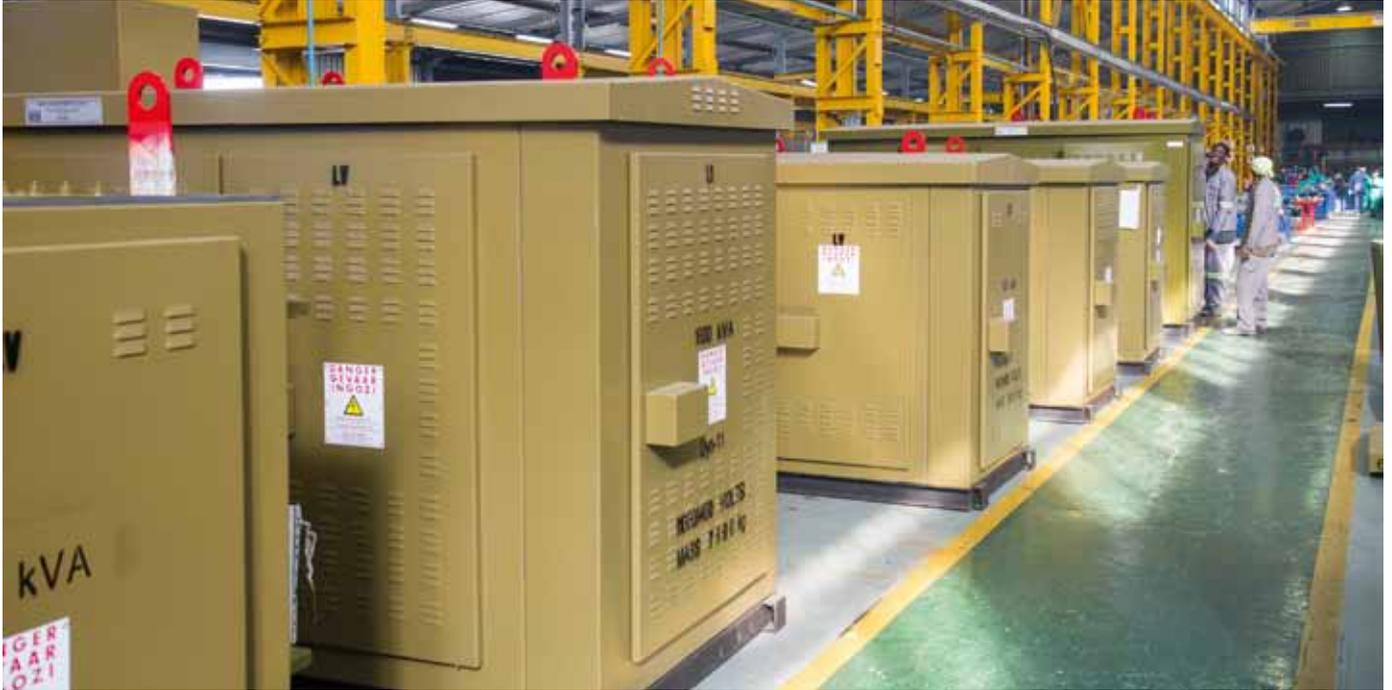
*The WTA mini substation production line.*
